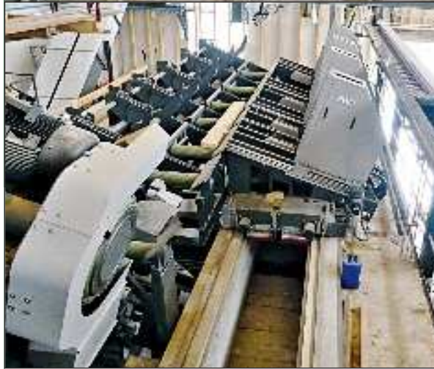
In der 12 m hohen Sägehalle steht die Blockbandsäge auf 5,50 m Arbeitshöhe, die Nachschneiteinheit auf 6,20 m (Foto oben: Hegener-Hachmann). Links der um 17° geneigte EWD-Blockbandsägewagen, Spannerscheibe und Kappsäge
