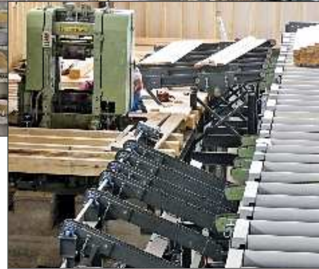
Vor Ort von EWD generalüberholtes Esterer-Gatter „HDN 600SV“, rechts im Bild der Rollengang für den Model-Transport von der Blockbandsäge. Durch den absenkbaren Querförder (vorne) ist ein Material-Rundlauf möglich.
