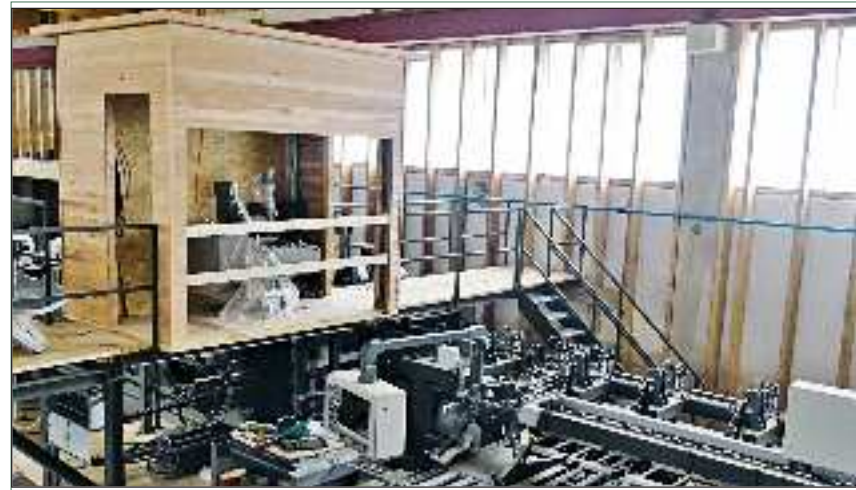
Bei der Anlagengestaltung ging es auch um größtmögliche Übersicht für die Anlagenfürer zur Qualitätsbeurteilung sowohl des Rund-, als auch des Schnittholzes: Im Bild oben der Blick vom Leitstand für den Rundholz-Bearbeitungsstrang, im Hintergrund die Einhausung der 3-D-Vollkonturmessung, rechts die Sägehalle. Im Bild unten der Leitstand an der „BNK“-Nachschneiteinheit – zusätzlich zum üblichen Kontroll-Panel an der Anlage – ermöglicht von oben eine bessere Sicht auf die Ware als von der üblichen Position des Bedieners aus.
